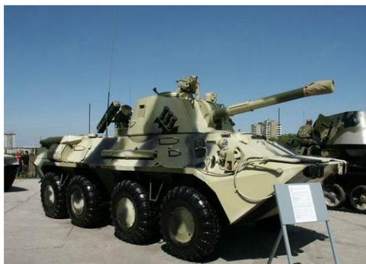
圖二 採用 BTR-80 裝甲輸送車底盤的 2S23 自行迫榴砲
