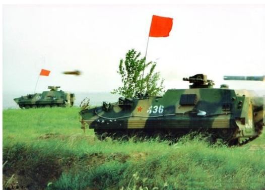
圖六 85 式反坦克裝甲車發射紅箭 8 型反坦克導彈
