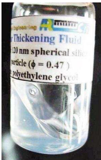
圖4 玻璃小瓶裏裝的淡藍色液體為“剪切增稠液體”
