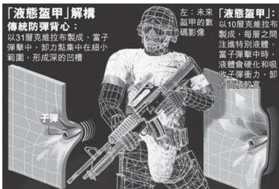
圖6 軟式防彈背心與液態盔甲的示意比較圖
