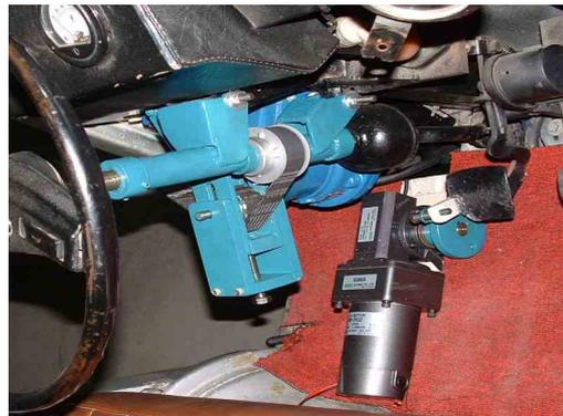
圖三 煞車踏板加裝電控馬達與凸輪
