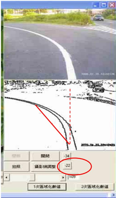
圖九 判別真實道路中，標線線條左彎之角度向左 22 度
