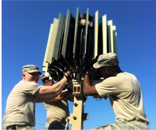
圖三 AN/MPQ-64「哨兵」(Sentinel) 防空系統雷達
