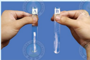
圖2 不同溫度的鹽酸水溶液與鎂帶的反應
