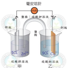
圖8-8 鋅銅電池的構造
