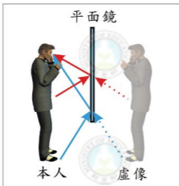
圖 13-13 平面鏡成像原理
