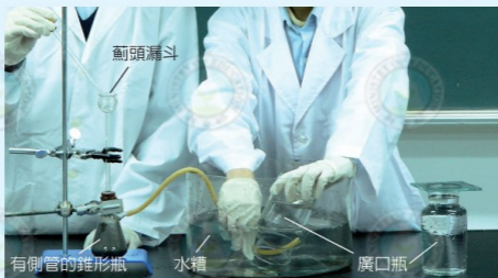
圖1 製造氧氣實驗裝置
