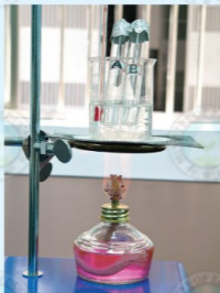
圖 1 酯類製造實驗裝置圖
