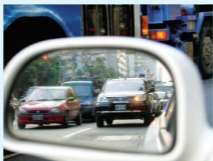
(b) 某些汽車的照後鏡（凸面鏡）：增加視野，但因為成像變小，所以會有錯覺，似乎後方車子在較遠的地方。
