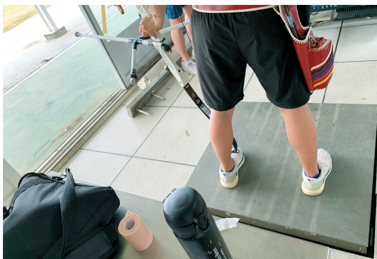
圖3 使用測力板量測選手放箭時的重心穩定度
