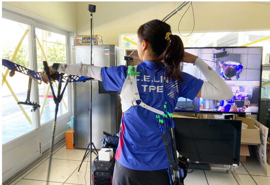
圖2 使用無線EMG量測選手射箭時的肌肉活化情形
