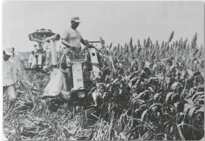
▲ 高粱聯合收穫機田間收穫示範 (圖：行政院農業委員會農業試驗所提供)
