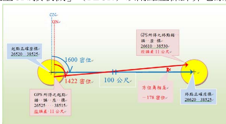
圖三 「精確輕型GPS接收機」(PLGR)以兩點座標計算地線方位之誤差示意
