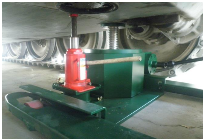
圖十二 液壓式千斤頂承載重量示意圖
