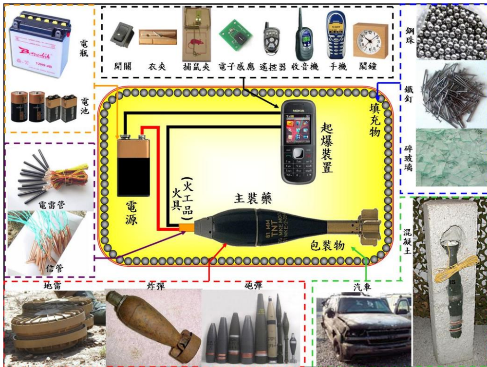
圖 2：應急爆炸裝置組成示意圖
