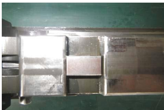
圖5：槍機閉鎖鐵槽變形
