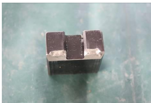
圖2：閉鎖鐵斜面變形
