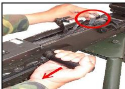
圖15：以116 樣板插入耳軸
