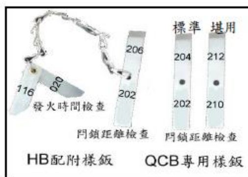
圖 14：門鎖距離檢查樣板
