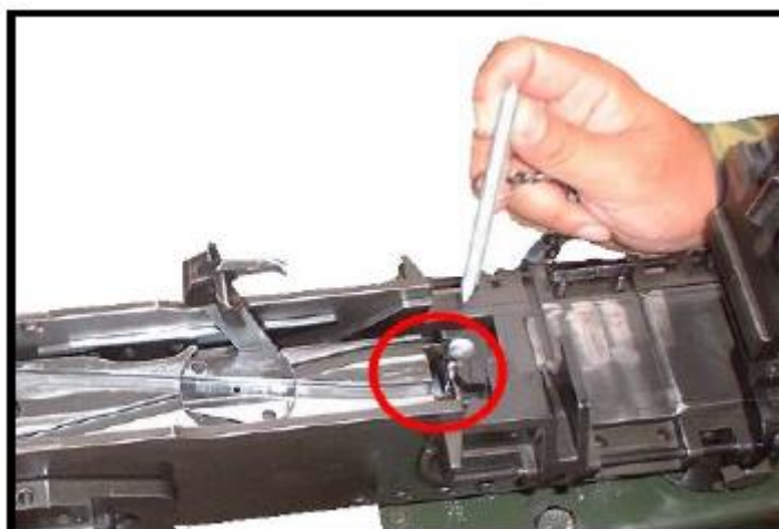
圖 13：M2-QCB 式50 機槍門鎖距離檢查位置
