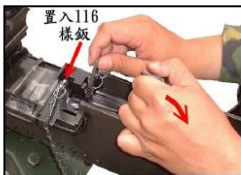
圖 16：左手收縮最後游隙後再插入樣鈹
