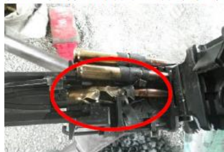
圖 10：熱噴流引發下一發彈藥瞬燃
