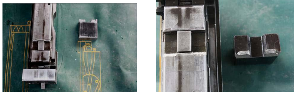
圖 3 槍機閉鎖鐵槽變形 圖 4：閉鎖鐵斜面變形
