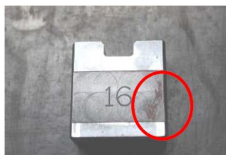
圖12：委製閉鎖鐵表面鏽蝕
