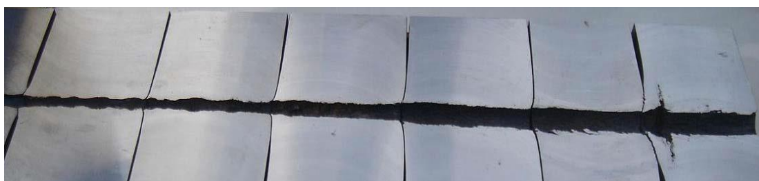
圖十二 金屬噴流貫穿鋼板
