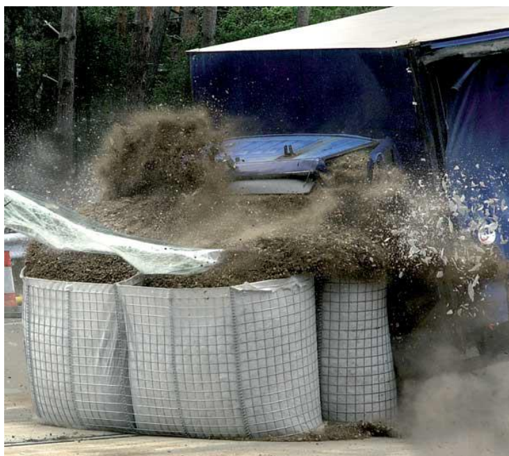
圖5：有效阻擋30 噸卡車以時速90 公里的衝撞。
