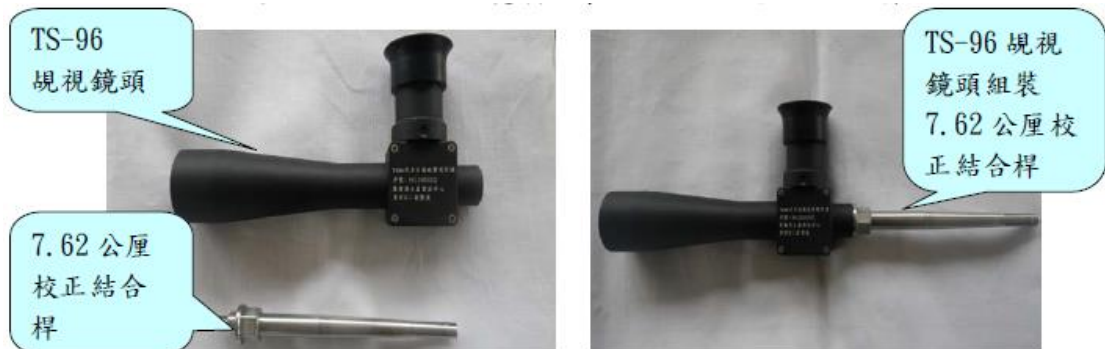
圖二：TS-96 規視鏡頭組裝 7.62 公厘校正結合桿
