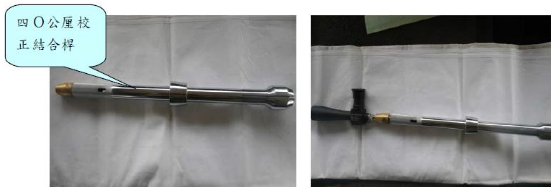
圖四：TS-96 覘視鏡組裝四〇公厘校正結合桿
