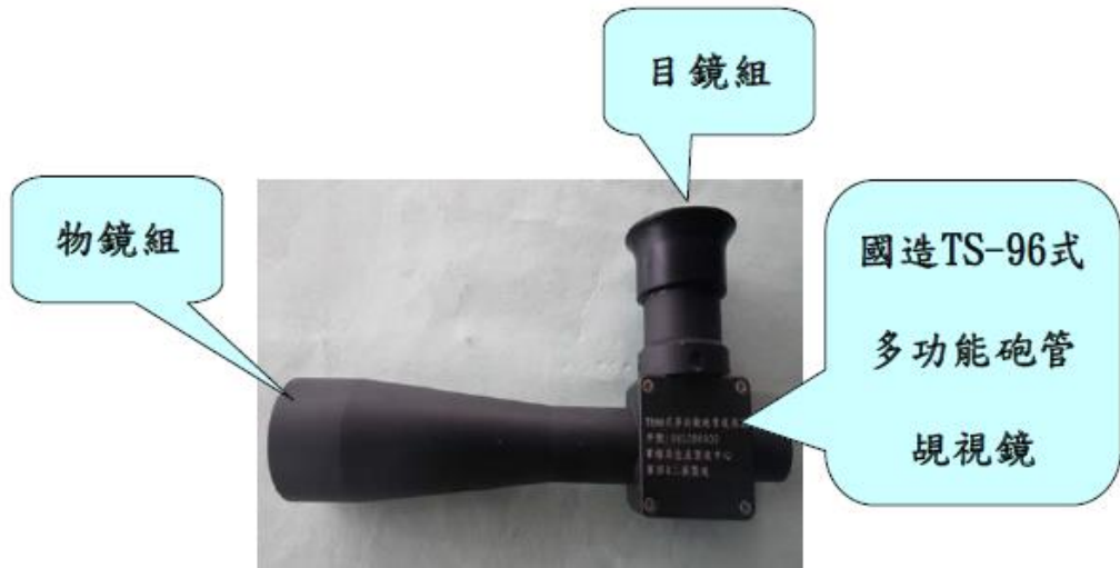
圖一：TS-96 式多功能砲管覘視鏡
