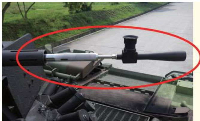
圖五：四〇公厘榴彈機槍規視鏡校正
