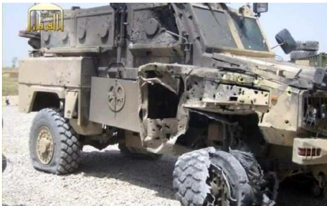
圖11：美軍RG-31 防地雷通用車遭爆炸成形彈攻擊損毀
