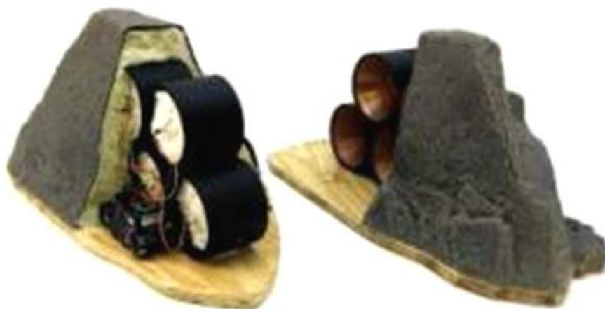
圖14：將多個爆炸成形彈組裝在一起，獲得最佳殺傷面積
