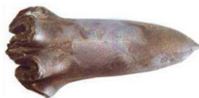
圖5：藥型罩經擠壓變形後形成的彈體，有良好氣動穩定外形
