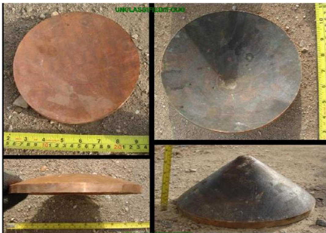
圖7：不同錐角角度的圓錐形藥型罩
