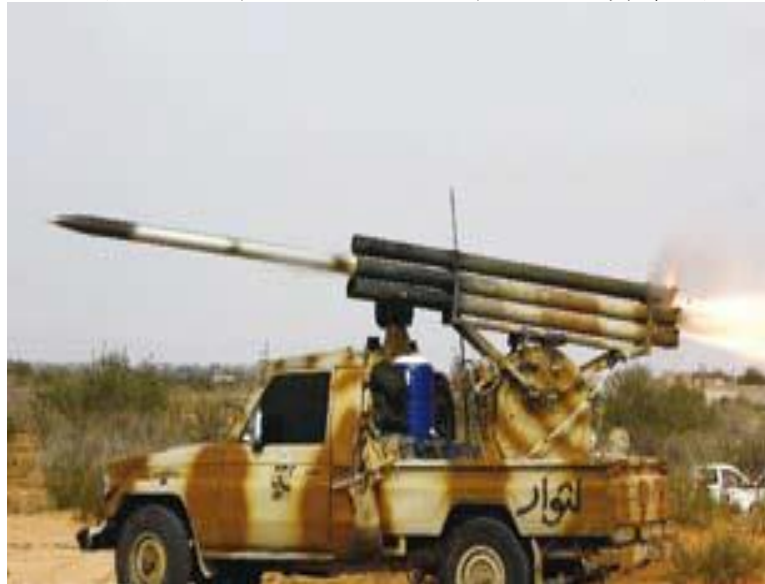
圖二 四管 122 公厘火箭發射器貨卡圖
