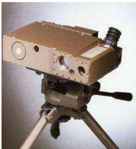
圖一：DHY307 手提式陸基雷射目標測距指示器
