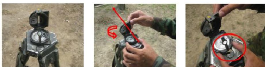
圖2 以帆布套撐托指北針實施射向賦予組圖
