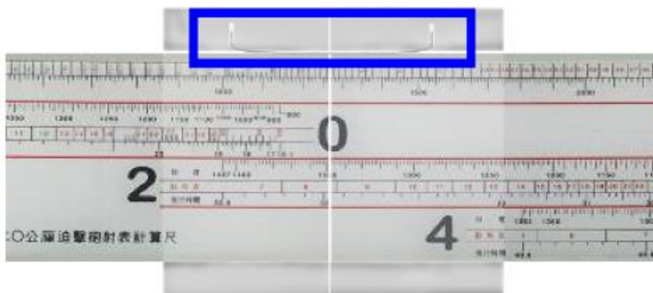
圖十二. 雙邊固定式之緊定簧示意圖
