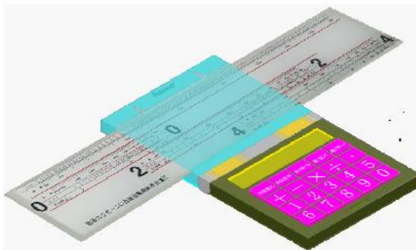
圖十三.120 砲射表計算尺之新增裝置示意圖
