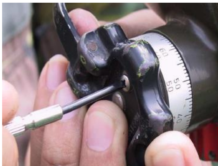
圖十五：方向輔助分劃校正
