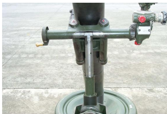
圖七：方向機T 型螺母居中
