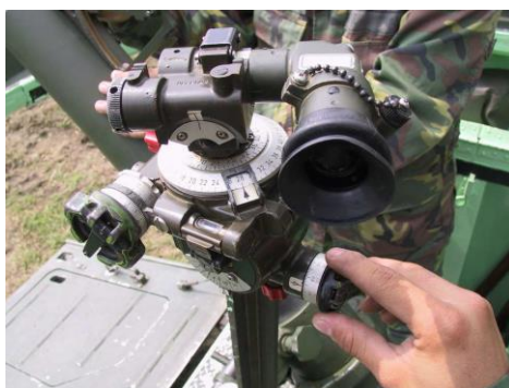
圖十：高低補助分劃校正
