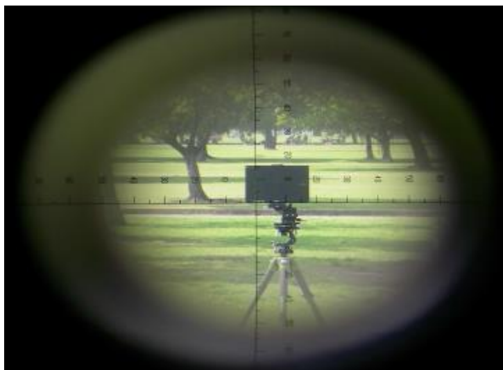
圖十四：瞄準具之視軸線重疊於校正線上
