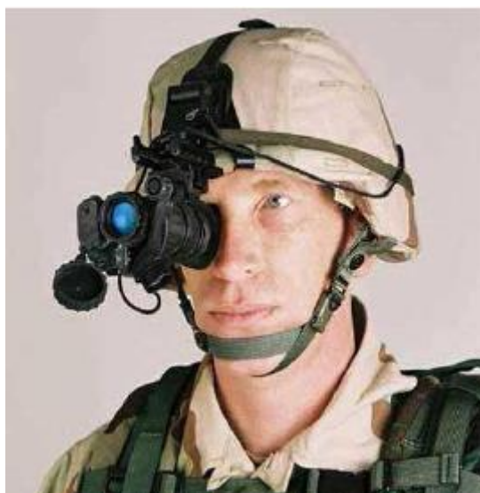
圖4：AN/PVS-14 型單管夜視鏡
