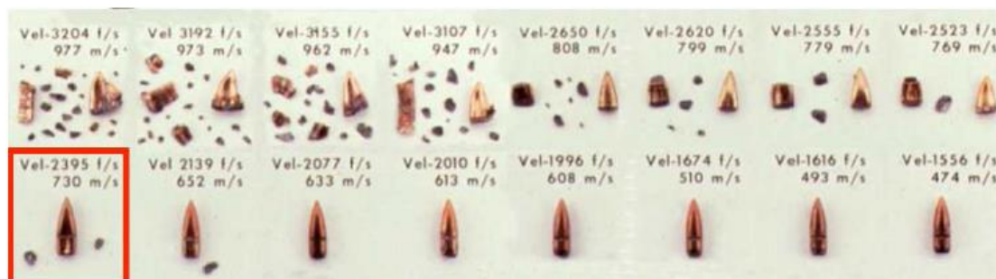
圖8：彈丸於各種初速撞擊後破碎程度比較圖
