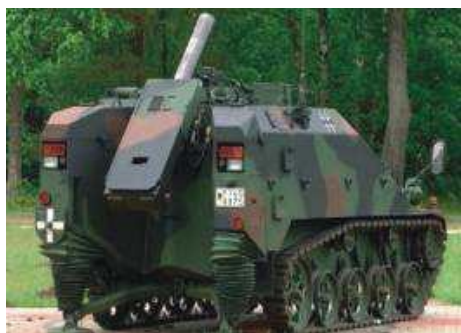
圖2、「Wiesel-2迫擊砲車」獨特的砲塔設計及反後座裝置
