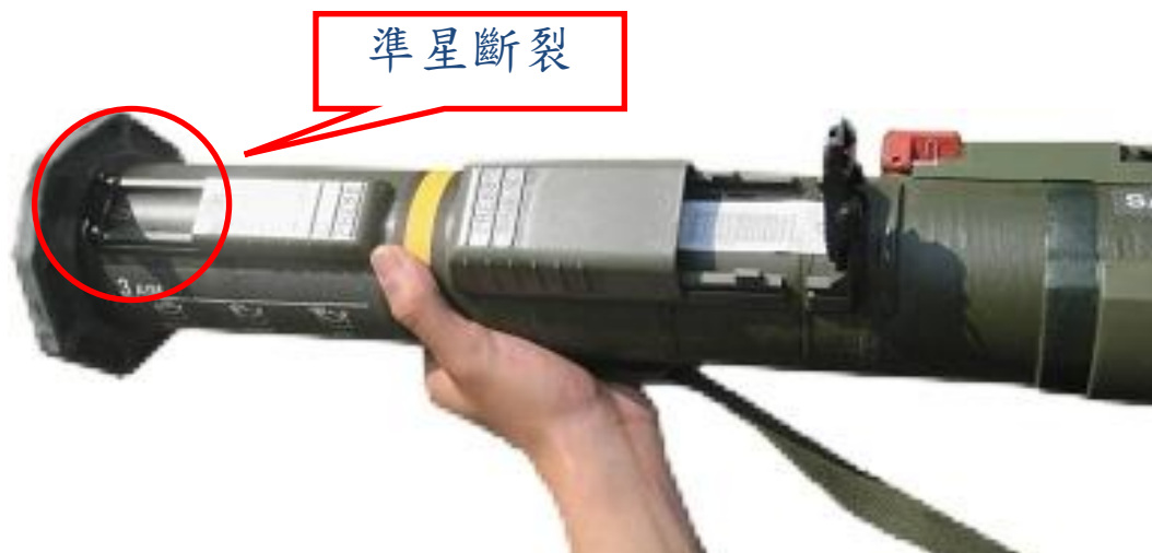
圖 8: 檢查瞄準具有無斷裂
