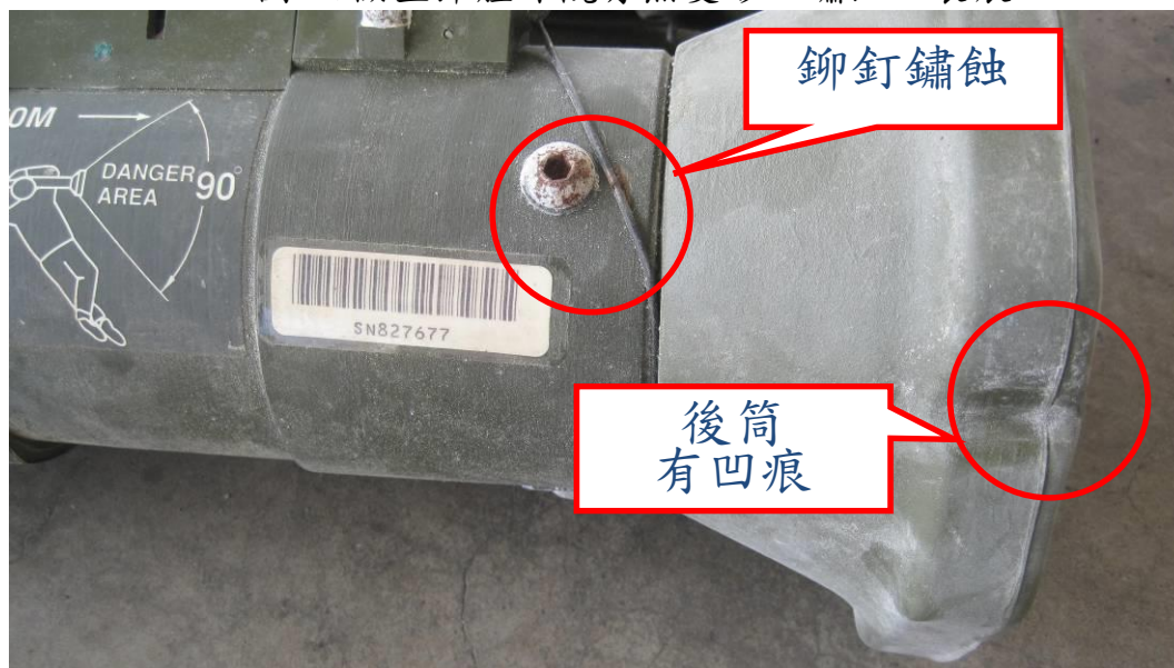
圖 7: 檢查彈體外觀有無變形、鏽蝕、裂痕
