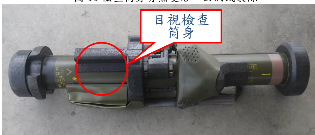
圖 10 檢查筒身有無變形、凹洞或裂隙
