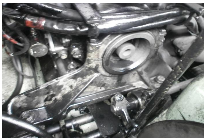
圖三 引擎機油漏油現況圖
