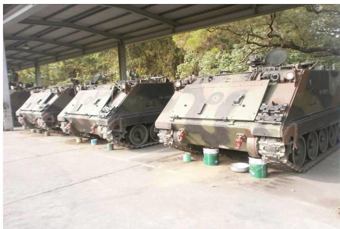
圖一 甲車接漏機油現況圖
