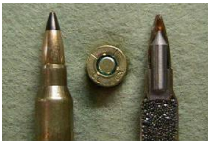
圖 2：M995 穿甲彈彈頭結構
