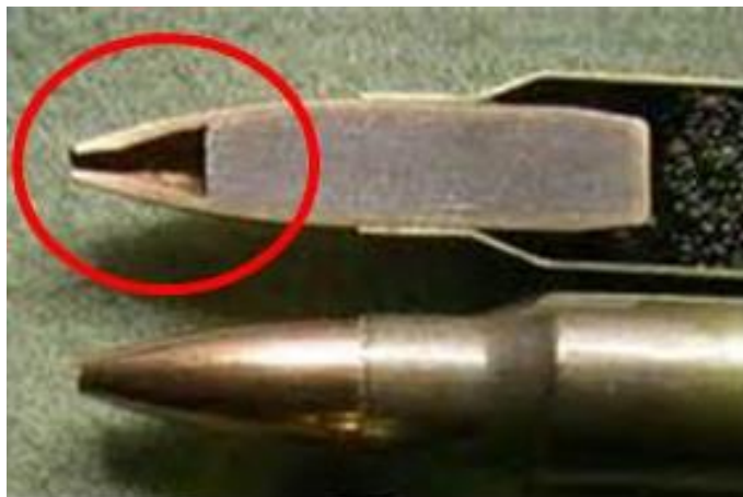
圖 5：彈頭披甲開尖設計結構
