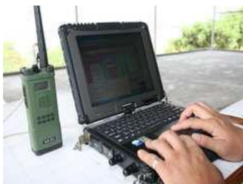
圖三 以HR-93 搭配軍規電腦之「迫砲射擊指揮資訊化系統」
