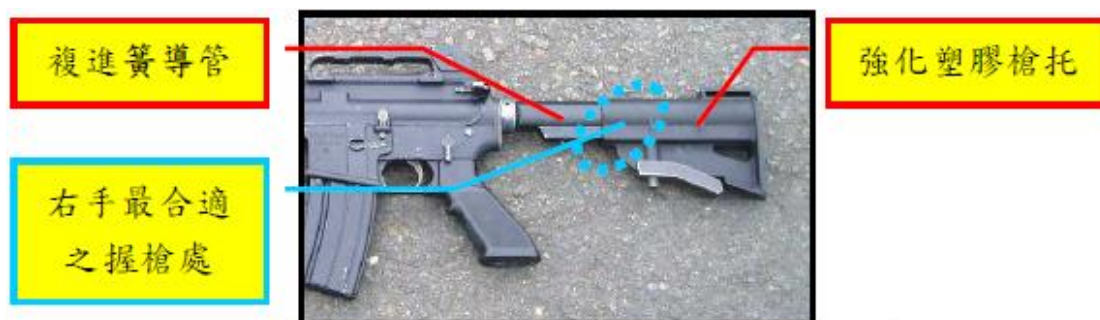
圖十：「複進簧導管」與「強化塑膠槍托」之「接合處」
