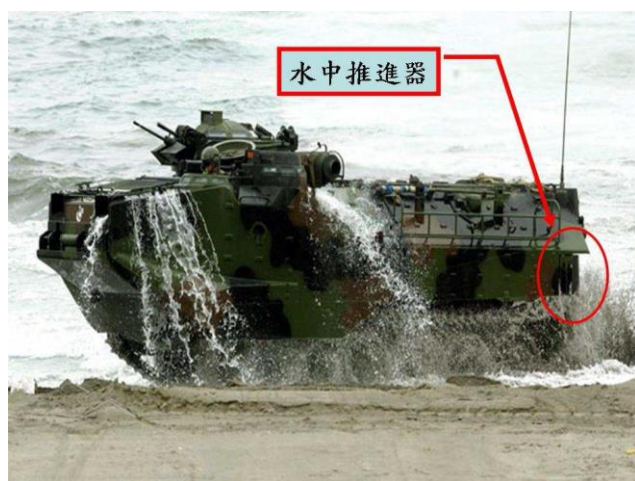
圖四：陸戰隊AAV7 水中推進器示意圖
