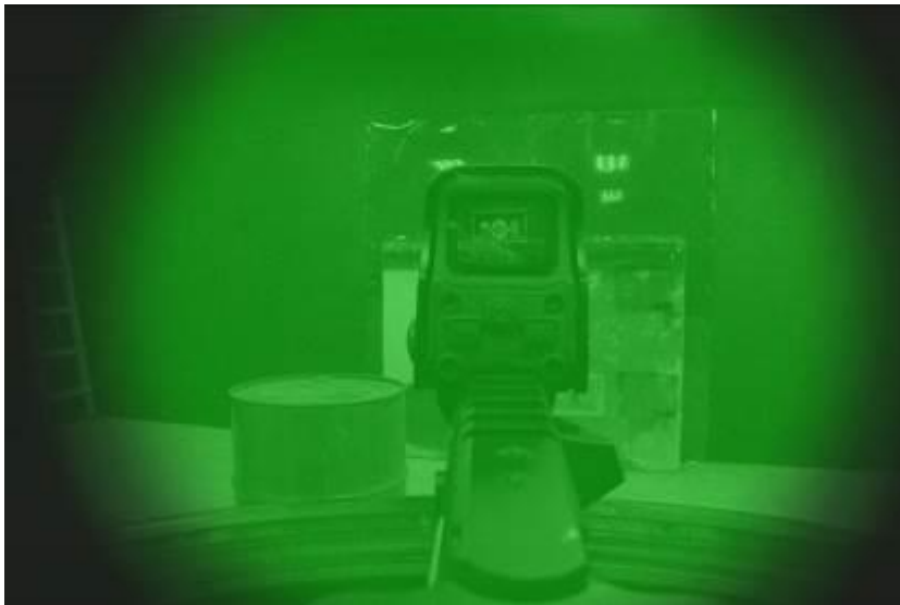
圖七 星光夜視鏡觀測下內紅綠光快速瞄準器
