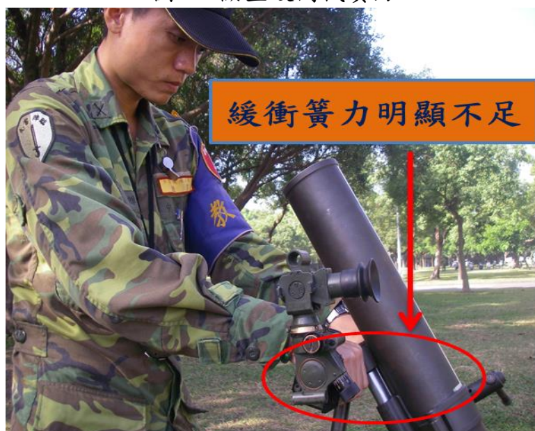
圖八 檢查緩衝機簧力
