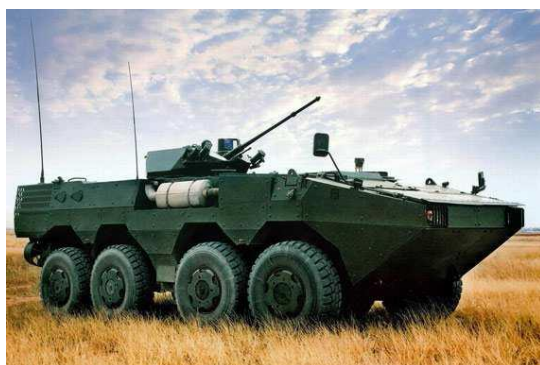
圖三：ZBD-09 8x8輪型步兵戰車野外機動性能測試。
