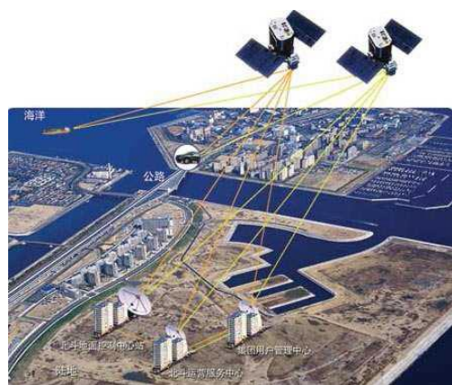
圖五 北斗導航衛星工作示意圖
