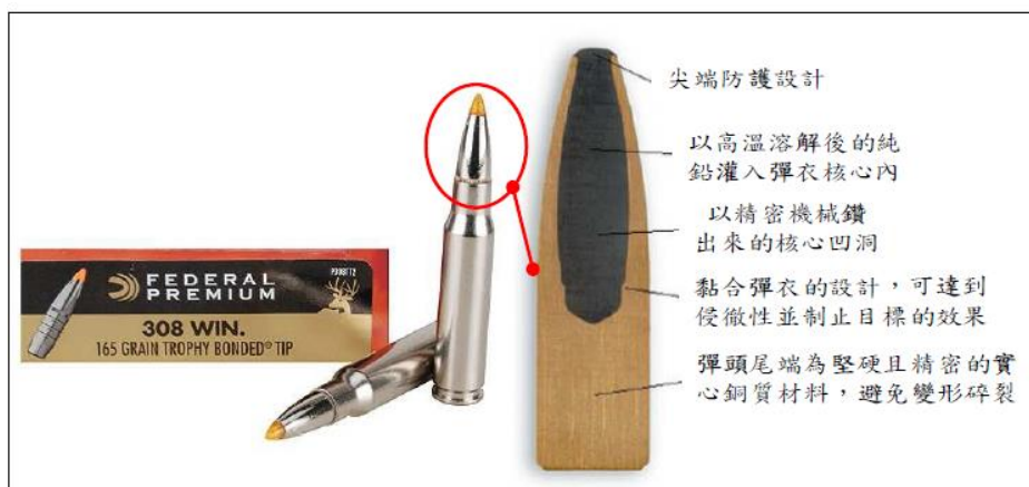
圖十八 Trophy Bonded 彈頭設計剖面示意圖
