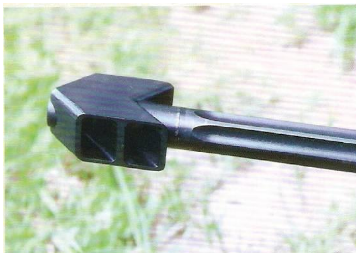
圖三 M107狙擊槍採用雙梯形制退器
