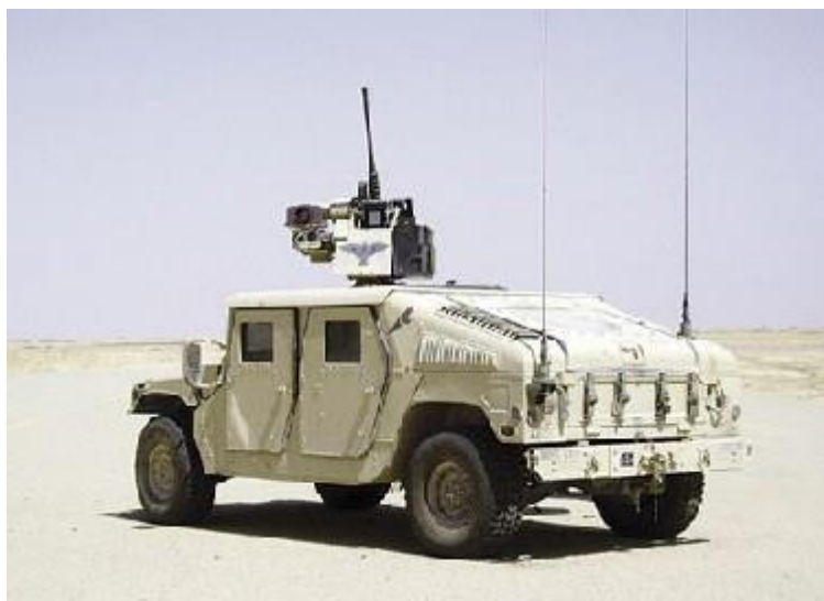
圖三:安裝 Recon/Optical M101通用遙控武器系統之悍馬車
