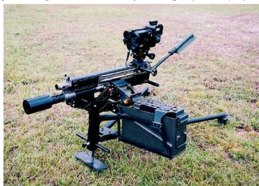
圖四 SLWAGL40mm 榴彈機槍同三腳架僅重 25 公斤
