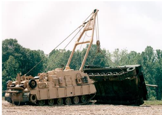
圖二 M88-A2「大力士」裝甲修復車搶修戰甲車情形
