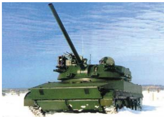
圖二 以 BMP-3 步兵戰車車體為底盤研製的 2S31 維納 120 公厘自走迫擊砲 資料來源： http://jczs.news.sina.com.cn/2005-02-17/1120266659.html
