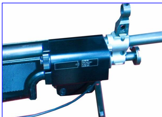
圖七：雷射發射器與班用機槍結合
