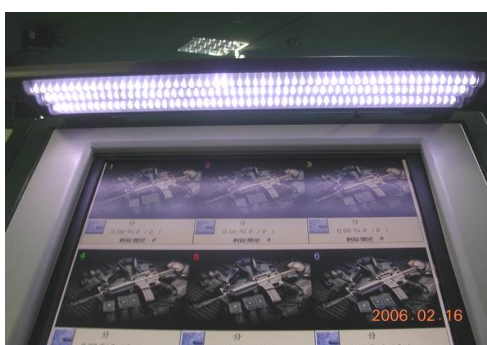
圖十六 機櫃 LED 燈光照明裝
