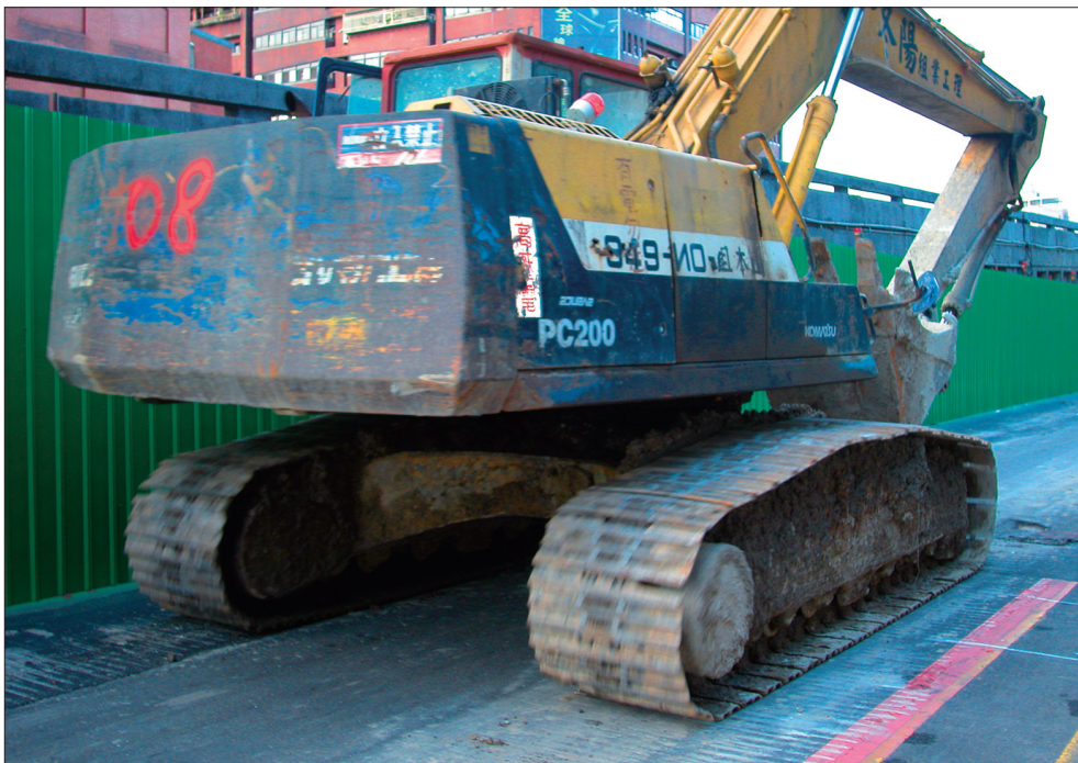
圖2-15 履帶裝置——如蛇面狀的移動 履帶構造與蛇類的移動方式類似，藉由與地面產生大面積的摩擦力，可在凹凸不平的表面移動自如。
