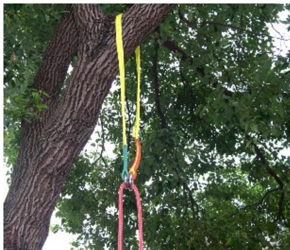
圖4 人為支點的金屬環提供掛點內的滑動性
