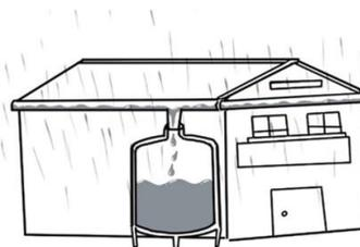
下雨時，雨水會沿著屋簷流入溝渠，最後接到雨水撲滿裡。
