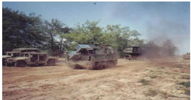
圖 7 M817 工兵傾卸車
