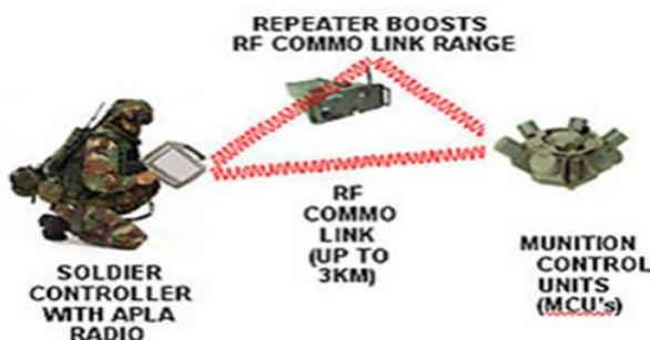
圖 11 士兵透過無線電控制 XM-7「蜘蛛」智能地雷
