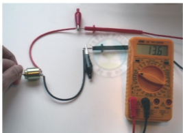
圖11-12 將玩具馬達的兩個接頭以伏特計或數位電表連接，接著用手轉動馬達轉軸，則伏特計便會偵測出一個電壓。
