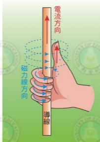
圖10-17 運用安培右手定則來判斷通電長直導線周圍磁場的方向
