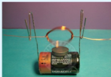
圖5 線圈置上，輕觸使之開始轉動，馬達完成了。
