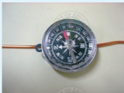
(b) 磁針在導線上方通電後的偏轉現象
