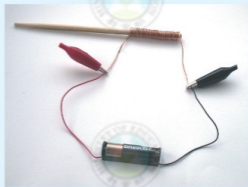
(d) 分別放入鐵釘及竹筷測試電磁鐵性質
