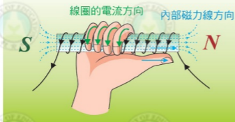
圖10-18 當通有電流的直導線繞成環圈時，導線周圍的磁力線會聚集起來。
