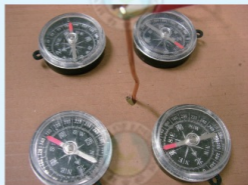
(f) 磁針遠離導線偏轉情形
