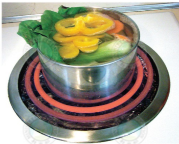
圖11-6 有些爐具是透過鎳鉻合金（圖中紅熱之金屬環）將電能轉換為熱能來烹煮食物
