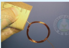
圖1 其中一端引線的絕緣漆全部刮除
