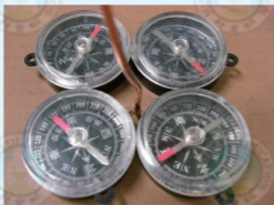
(e) 垂直長直導線通電後四周磁針偏轉現象
