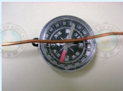
(c) 磁針在導線下方通電後的偏轉現象
