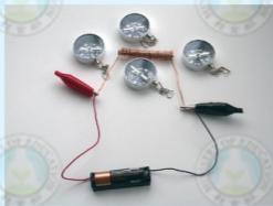
(c) 以磁針決定通有電流的螺旋線圈兩端及周圍之磁性（請比較本圖與(b)圖磁針方向）
