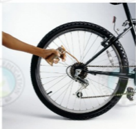
圖12-17 鏈條和鏈輪的傳動，應用在腳踏車上。
