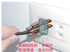
圖11-19 用手拉扯電線時，可能導致細銅絲鬆脫，使得兩片金屬片直接導通，巨大的電流直接在插頭形成迴路，並引起高热爆炸。
