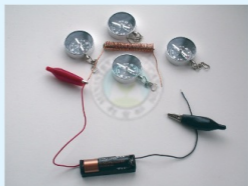
(b) 以磁針決定未通電流時螺旋線圈兩端及周圍之磁性
