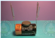
圖4 以膠帶將迴紋針黏貼在兩極，並將磁鐵吸附在電池上。
