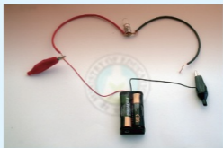
(b)斷路（注意到右側黑色鱷魚夾未將導線接通）
