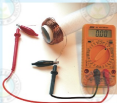
(a) 螺旋線圈兩端引線絕緣漆刮除後，串聯數位電表檢測電流。
