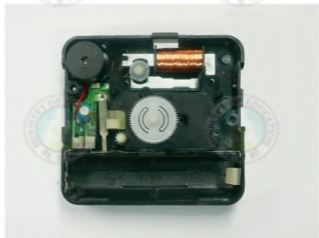
圖12-12 時鐘內部的直流馬達帶動齒輪，進而使指針轉動。
