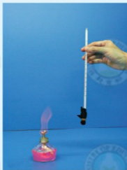
圖5 包黑布於溫度計底部的熱輻射實驗
