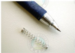
圖 4-9 自動原子筆充分運用彈簧的彈性
