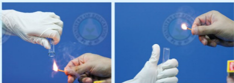
圖2 以火柴餘燼檢查倒置的A 圖3 以燃燒中的火柴檢查正立的B 試管內的氣體 試管內的氣體
