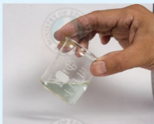
圖 2 加熱過的銅片與稀硫酸反應後的濾液
