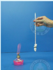
圖6 包白布於溫度計底部的熱輻射實驗
