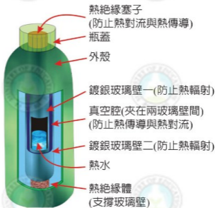
圖 3-15 保溫瓶的設計可有效阻絕熱傳播的三種機制示意圖（塞子與真空腔可防止傳導與對流；鍍銀可防止輻射）。
