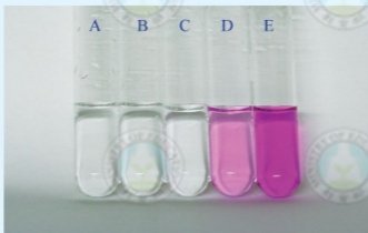
圖3 五種水溶液滴加酚酞指示劑後的顏色比較
