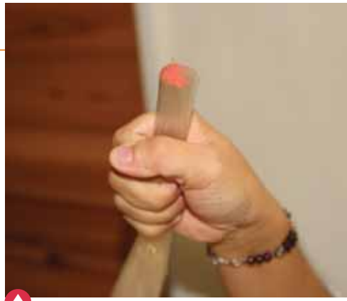
▲ 這裡有個實驗器材，把開關打開，小燈泡的光亮會透過線的傳輸，在另一端發亮，這就是光纖的應用喔！
