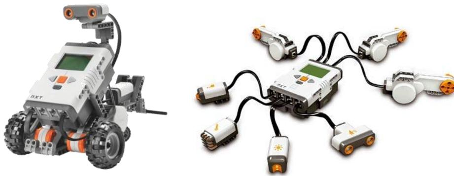
以目前中小學所採購的機器人模組系列，包含樂高機器人 NXT9797(本體模組)+LEGO9695(擴充模組)，NXT 教育版 9797 有 431 個零件，樂高原廠全新推出的 9695 LEGO 擴充零件組（9695 LEGO MINDSTORMS Education ResourceSet），配件套裝多達 817 個各種各樣的元件，不僅可用於組裝 NXT 藍牙機器人，也是科學和技術套裝的配件庫。
